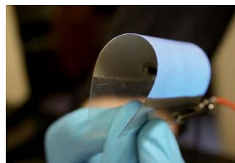
Abb. 3: Elektrolumineszenz-Bauteile mit transparenten Elektroden aus einwandigen CNTs
