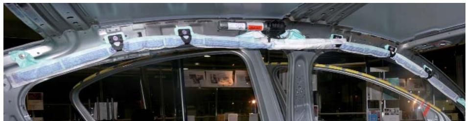
Abb. 1: Seitenairbag mit Schutzhülle in einer VW-Passat-Karosserie
