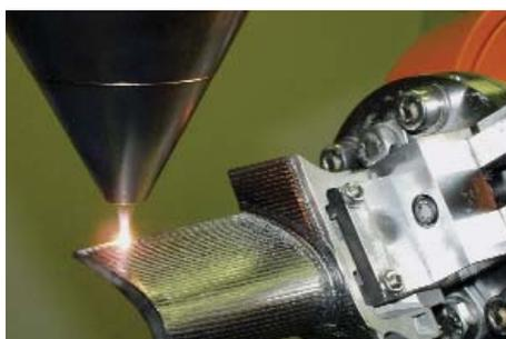
Reparatur von Gasturbinenschaufeln durch Auftragschweißen mit Hochleistungs-Diodenlaser
