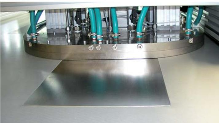
Abb. 2: Beweglicher AP-CVD-Beschichtungskopf zur Abscheidung auf Substratgrößen bis  $300 \times 300\text{ mm}^2$
