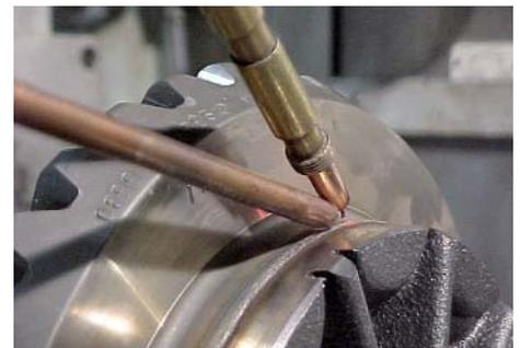
Abb. 7: Laserstrahlschweißen mit Zusatzwerkstoff, Ausgleichsgetriebegehäuse (Gusseisen) mit Zahnrad (einsatzgehärteter Stahl)
