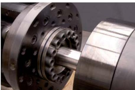
Servohydraulische Torsions-Axial-Prüfmaschine in Aktion
