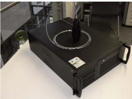
Abb. 2: Entwickeltes Mess- und Regelsystem (19"-Einschub mit Pyrometeroptik an Lichtleitfaser)
