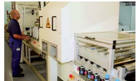
Abb. 2: Produktionsanlage im Geschäftsbereich ProTech der Schreiner Group GmbH & Co. KG zur Fertigung von Airbagschutzhüllen
