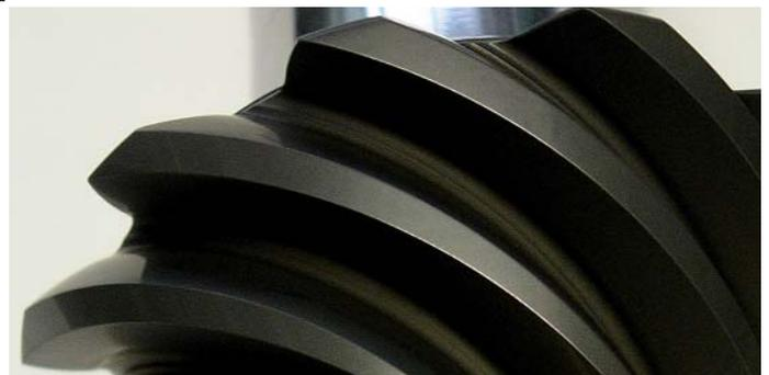
Abb. 3: Mit einem optimierten ta-C / a-C-Mehrlagenschichtsystem beschichtetes Zahnrad
