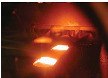
Metallverdampfung mittels Elektronenstrahltechnologie
