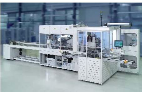
Abb. 3: Laserlötanlage der Firma teamtechnik Maschinen und Anlagen GmbH in Freiberg a.N.
