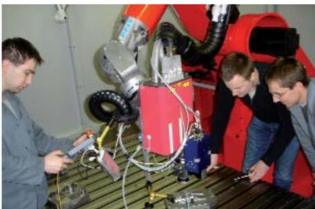
Inbetriebnahme der roboterbasierten Laserhärteanlage in Slowenien
