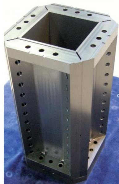
Abb. 1: Vier mit Diamor® beschichtete Seitenwände eines kleineren Speichergefäßes (aus Aluminiumvollmaterial gefräst) im Design der großen Speicherflasche des nEDM-Experiments
