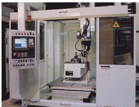
Laserstrahlschweißanlage mit 6 kW-CO<sub>2</sub>-Laser
