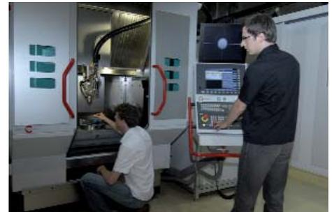
3-Achs- und 5-Achs-CNC-Fräsmaschinen mit Laser-Bearbeitungsmodulen zur Komplettbearbeitung aus Laser-Auftragschweißen und Fräsen
