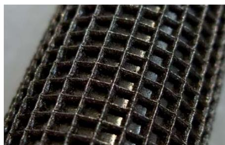
Abb. 2: Mittels Faserlaser auftraggeschweißte Strukturierung einer Testprobe
