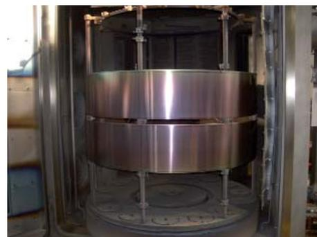
Abb. 2: Zwei auf Edelstahlblechen aufgespannte und mit Diamor® beschichtete PET-Folien nach der Beschichtung in der Großkammeranlage
