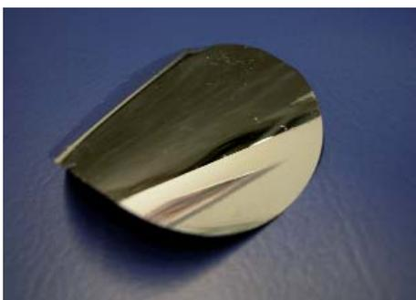
Abb. 3: Freistehende Ni/Al-Reaktivmultischicht
