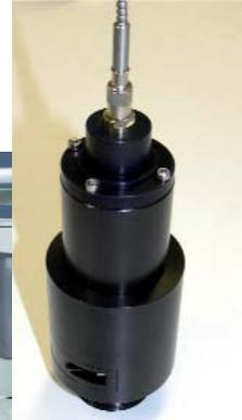
Lötanlage der Firma teamtechnik Maschinen und Anlagen GmbH Freiberg mit integriertem Temperaturregelsystem des Fraunhofer IWS, oben: Optik mit Filterhalter
