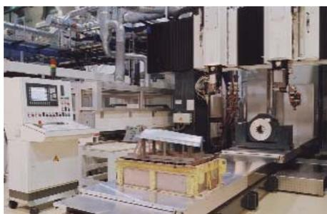
Hochgeschwindigkeits-3D-Laser-Schneidanlage mit Linearantrieben
