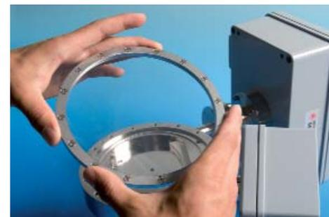
Abb. 3: Eingespannte Barrierefolie und geöffnetes Messsystem zur Bestimmung von Wasserdampfpermeationsraten mittels Laserdiodenspektroskopie
