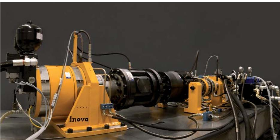
Abb. 2: Torsions-Axial-Prüfmaschine
